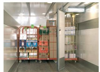
Mehrkammerfahrzeuge können nach Bedarf mit unterschiedlich großen Kammern ausgestattet werden und ermöglichen u.a. den gleichzeitigen Transport von Tiefkühl- und Trockenprodukten.
