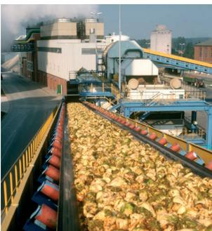
Ansatzpunkte für diese Entwicklung waren aus technologischer Sicht insbesondere Reduktionen von Wärmeverlusten, des Wassereinsatzes sowie der Kreisläufe von Stoffströmen. Hinzu kommen Effizienzverbesserungen bei der Kristallisation sowie der Zentrifugation.
