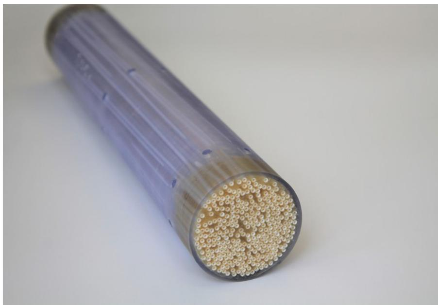
Polymere Hohlfasern sind als Membranen ideal, um unstete Strömungsformen und deren Auswirkungen auf das Fouling zu untersuchen.
